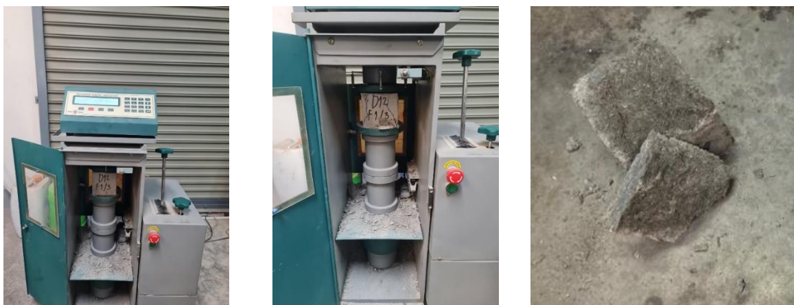
รูปที่ 3 การทดสอบกำลังอัดของตัวอย่างทดสอบทรงลูกบาศก์โดยเครื่อง Compression Machine
