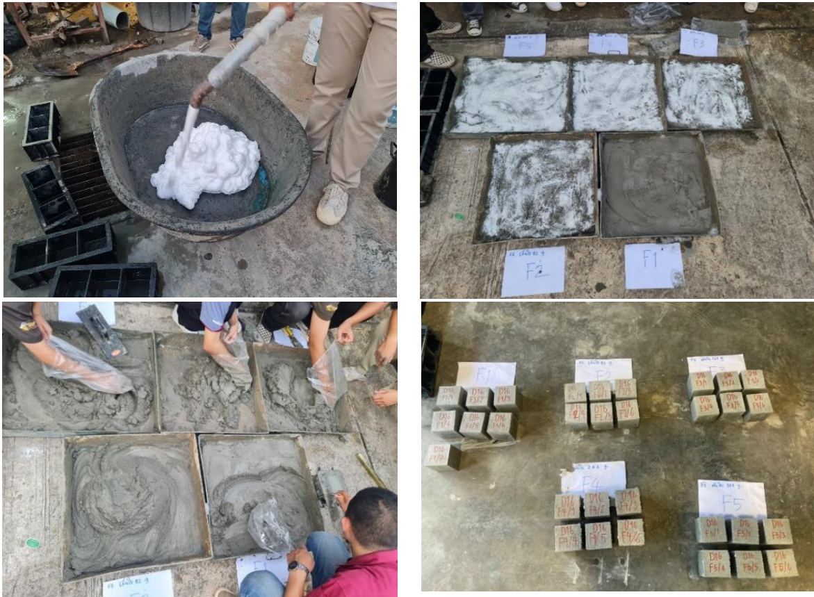
รูปที่ 2 การหล่อตัวอย่างทดสอบกำลังอัดทรงลูกบาศก์ขนาด 10x10x10 เซนติเมตร
