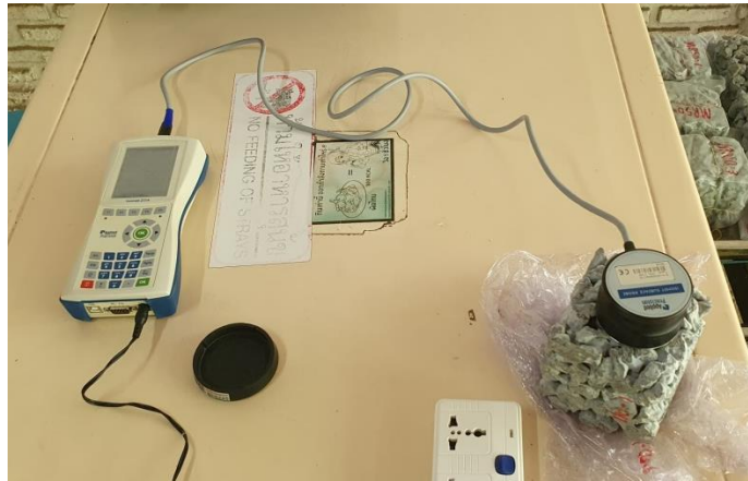
รูปที่ 4 การทดสอบค่าการนำความร้อนของคอนกรีตพูน
