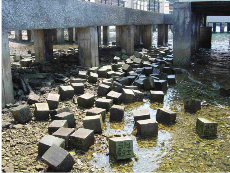
รูปที่ 2 ตัวอย่างคอนกรีตเพื่อศึกษาความคงทนของคอนกรีตที่ผสมเถ้าชีวมวลบดละเอียดในสิ่งแวดล้อมทะเลอ่าวไทย
