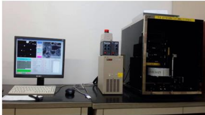
รูปที่ 8 การทดสอบหาระบบช่องว่างอากาศในคอนกรีตแข็งตัวแล้วด้วยกล้องจุลทรรศน์ตามมาตรฐาน ASTM C457 [15]
