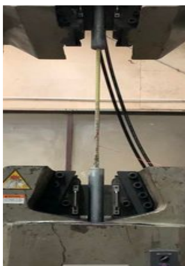
รูปที่ 3 ตัวอย่างการทดสอบกำลังรับแรงดึงของแท่งพอลิเมอร์เสริมเส้นใย [9]
