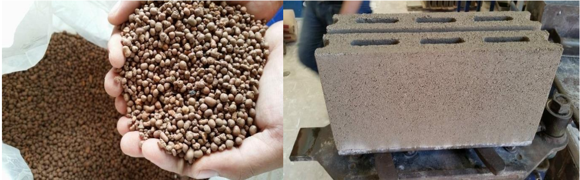
รูปที่ 5 คอนกรีตบล็อกผสมกับเม็ดดินเผามวลเบา:ผลิตภัณฑ์ก่อสร้างผสมซีเมนต์ที่ไม่รับกำลัง
