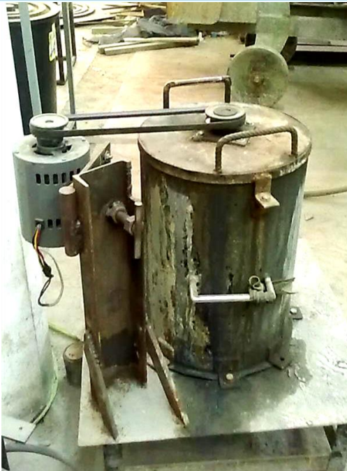
รูปที่ 2 เครื่องทดสอบการสีกร่อนตามมาตรฐาน ASTM C1138
