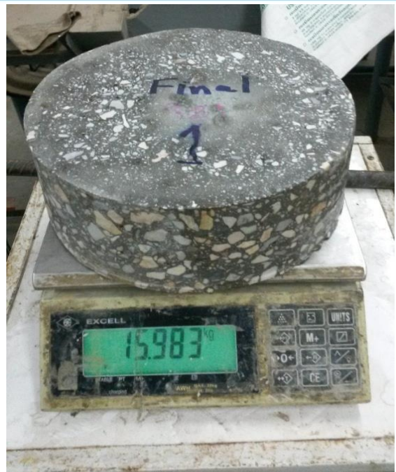
รูปที่ 3 การชั่งน้ำหนักตัวอย่างคอนกรีต
