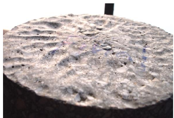
รูปที่ 5 ตัวอย่างคอนกรีตหลังการทดสอบครบ 6 รอบ
