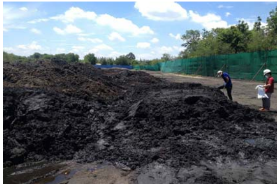
รูปที่ 4 กองเถ้าข่านอ้อยก่อนเผา และบ่อทิ้งเถ้าข่านอ้อย
