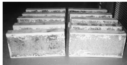
รูปที่ 2 ลักษณะของคอนกรีตบล็อกที่ใช้ในการทดสอบกำลังรับแรงกดอัด
