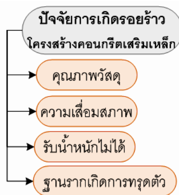
ภาพที่ 2 ปัจจัยการเกิดรอยแตกร้าวในโครงสร้างคอนกรีตเสริมเหล็ก
