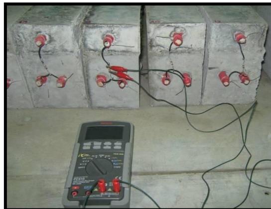
รูปที่ 2 การวัดกระแสของการเกิดสนิมตามมาตรฐาน ASTM G109-99
