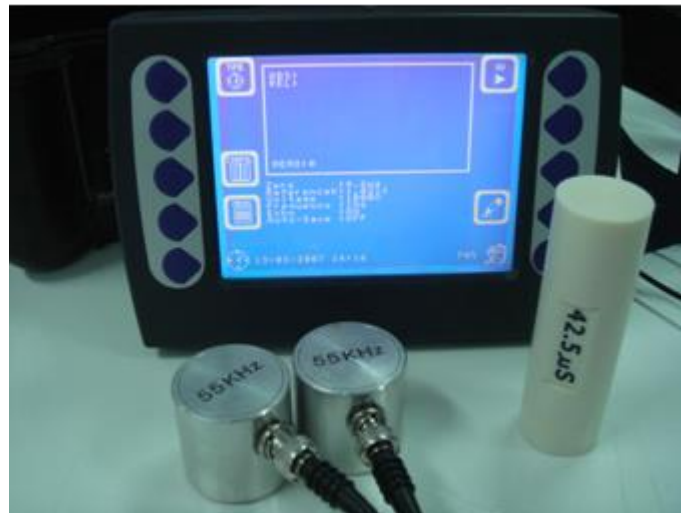
รูปที่ 1: ระบบการวัดความเร็วคลื่นอัลตราโซนิก
