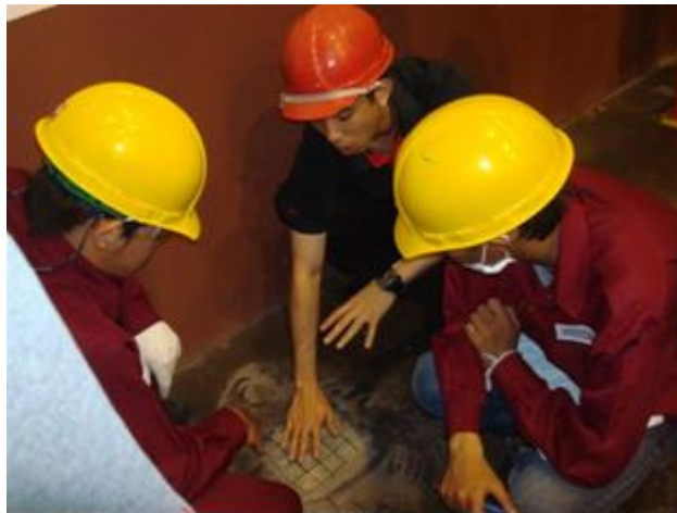
รูปที่ 1 – แสดงพื้นที่ส่วนที่ลอก Hardener ออก (มีการตีตาราง) แห้งเมื่อทิ้งไว้
