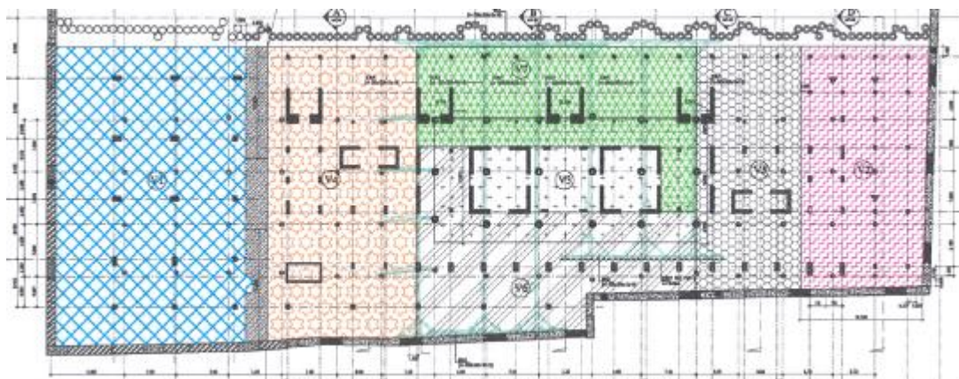
รูปที่ 5 ลำดับการเทฐานราก (รูปด้านบน)
