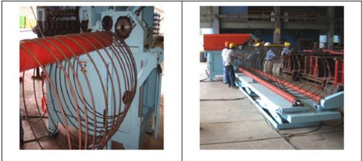
รูปที่ 10 เครื่องมือที่ใช้ขึ้นรูปเหล็กปลอกเกลียววงรอบใหญ่ (1)
