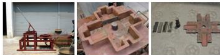
ภาพที่ 7 แม่พิมพ์ก้อนสำเร็จรูปแบบก้อนตัวเชื่อม
