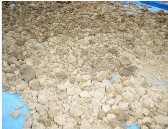
รูปที่ 1 ลักษณะของตะกอนน้ำประปាក่อนการปรับปรุงคุณภาพ (ดวงกมล สุริยฉัตร และคณะ, 2547)
